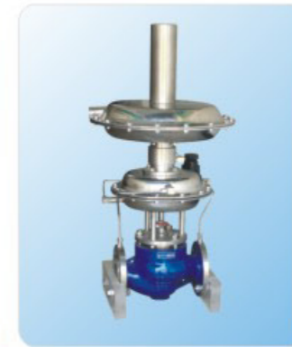
ZZYP-16 II型带指挥器自力式压力调节阀(氟密封)
